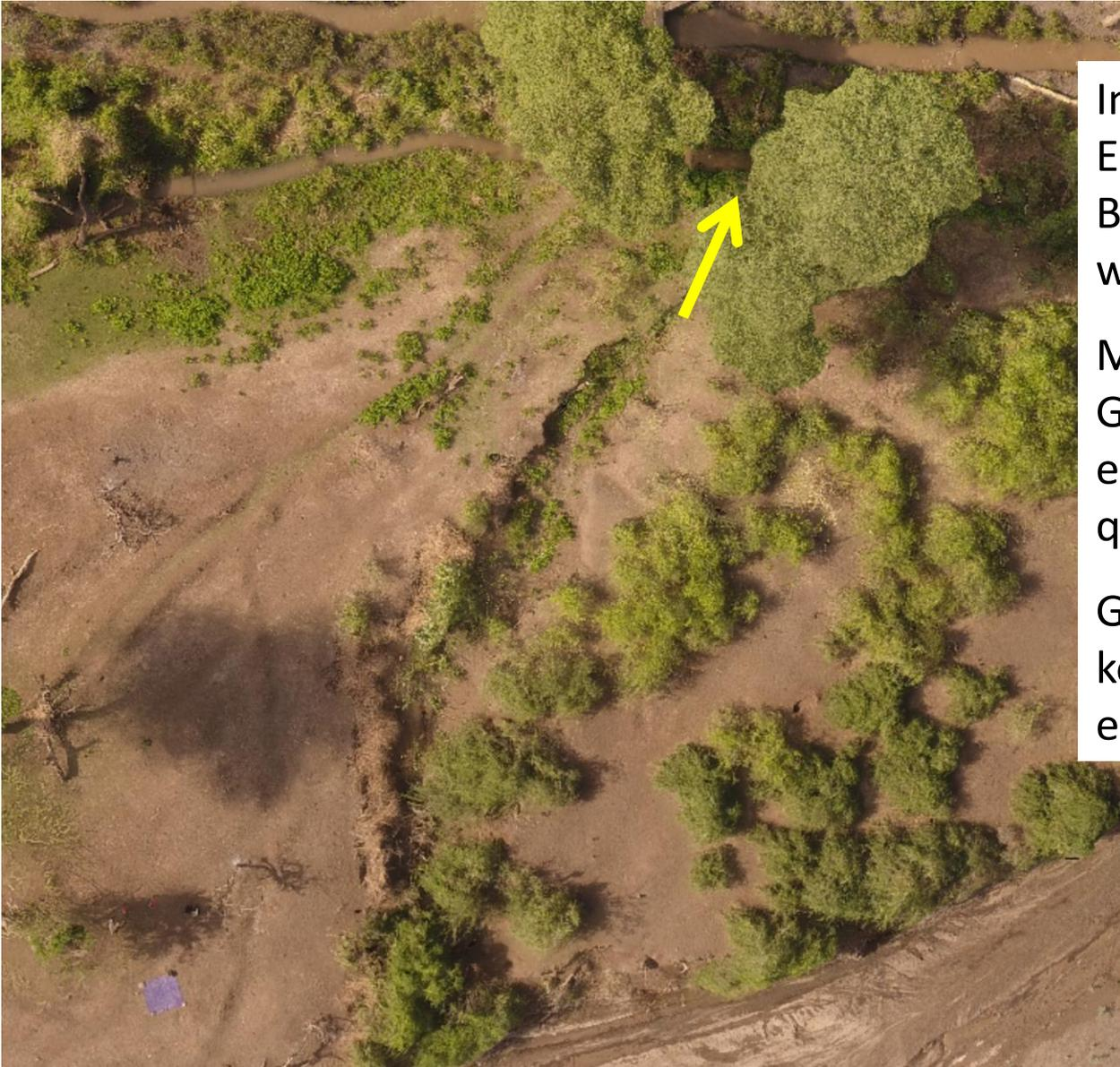
In 4,6 m erreicht die Erosionsrinne den Bewässerungskanal und wird ihn zerstören (Pfeil)
